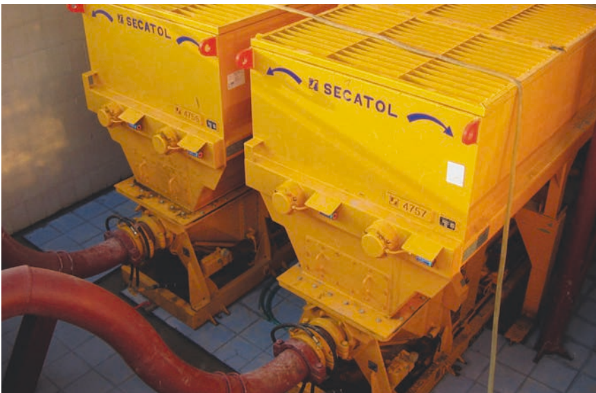
Zwei S-Rohrpumpen mit aufgebaumtem Secatol Einlauf- und Mischtrichter mit ca. 7 m 3 Fassungsvermögen
