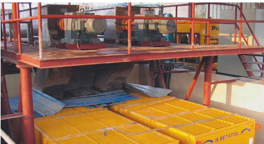
Zwei S-Rohrpumpen mit aufgebaumtem Secatol Einlauf- und Mischtrichter mit ca. 7 m 3 Fassungsvermögen
