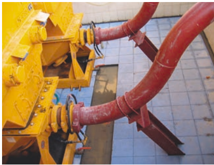
BLI Ringdüse mit Wasseranschluss zur Druckverlustreduzierung
